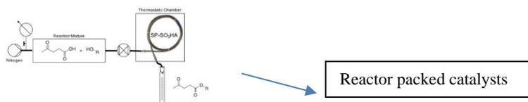
**Figura 1.** Prototipo di protocollo sintetico in flusso continuo.
